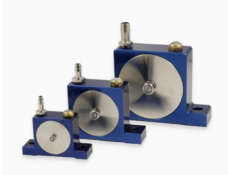
Le vibrateur à turbine VT se compose d'une turbine en aluminium, dans laquelle des masses en plomb sont intégrées. Le profil spécial de la turbine, en forme de lame, génère des fréquences élevées et de grandes amplitudes de vibration.
